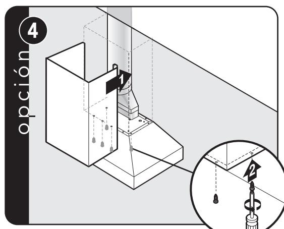
Deslice la tapa del conducto colocándola en su lugar y fije desde el interior de la cubierta con los tornillos para metal que se proporcionan.
