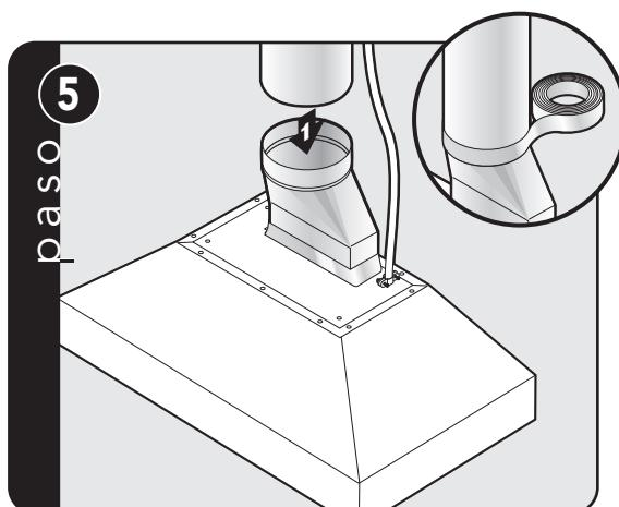
Deslice el conducto sobre la transición y coloque cinta alrededor de la unión.
