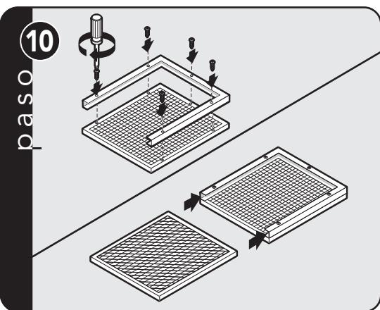
Monte los soportes en los filtros de malla e inserte los filtros de carbón.
