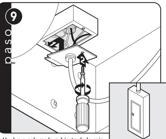
Vuelva a colocar la cubierta de la caja eléctrica. Haga la conexión a la caja del disyuntor.
