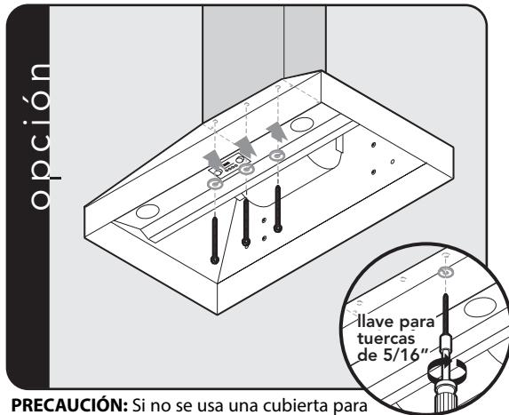
**PRECAUCIÓN:** Si no se usa una cubierta para conductos, con los tornillos suministrados asegúrese de que los tornillos de montaje superior queden asegurados en el plafón o en el bastidor del gabinete. Si es necesario, utilice tornillos de montaje adicionales.
