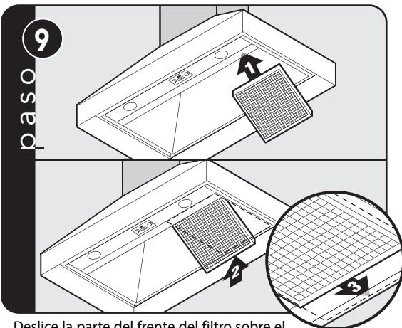
Deslice la parte del frente del filtro sobre el reborde frontal. Presione hacia arriba la parte posterior del filtro y luego deslícela sobre el reborde posterior.
