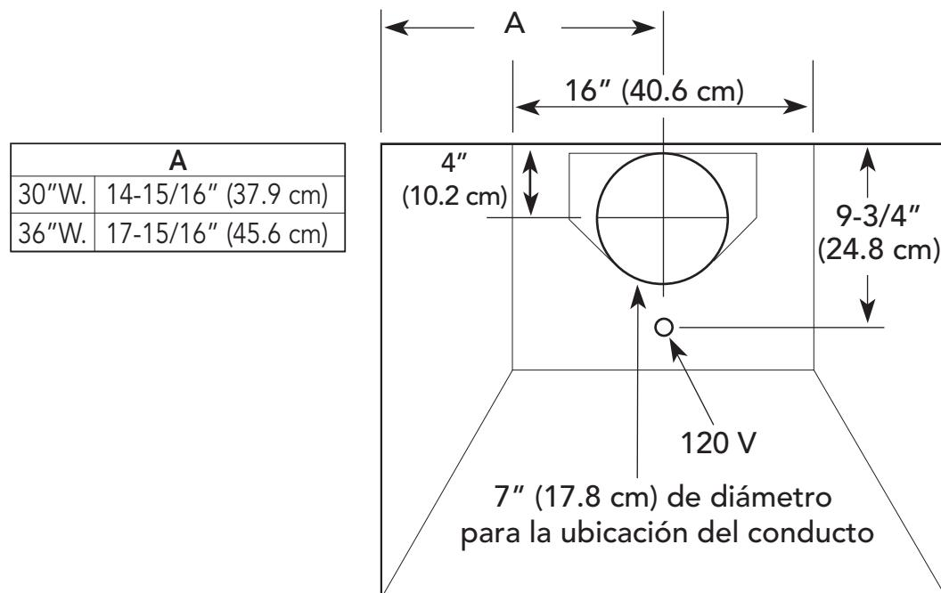
Instalación del ventilador interior de 460 CFM
