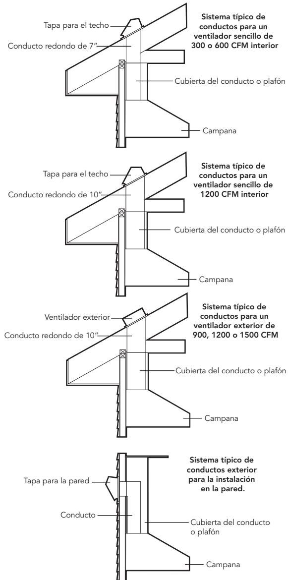
**NOTA:** El sistema de descarga montado en la pared debe estar a una altura mínima de 24" (61 cm) del piso. Esto puede variar dependiendo de los códigos locales y de la ubicación geográfica.
