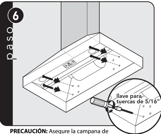
**PRECAUCIÓN:** Asegure la campana de ventilación en la pared usando los tornillos suministrados. Use tornillos de montaje y sujetadores de pared adicionales si es necesario.
