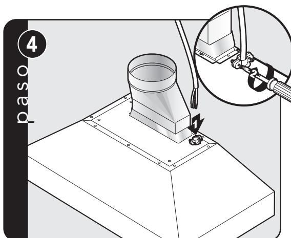
Inserte 6 pulgadas del cable eléctrico a través de la parte superior de la campana de ventilación y fíjelo con un sujetador de cables. Siga los códigos locales.
