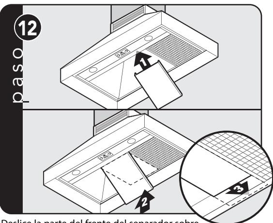
Deslice la parte del frente del separador sobre el reborde frontal. Presione hacia arriba la parte posterior del separador y luego deslícela sobre el reborde posterior.
