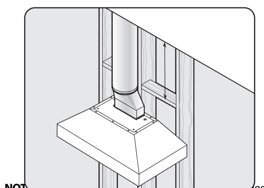
**NOTA:** Los tornillos de montaje entran en la estructura, no solo en la capa de yeso. Es posible que sea necesario hacer orificios adicionales en la cubierta para permitir una alineación adecuada. Para el montaje de algunas campanas, se requiere el uso de una tira de madera, que se puede comprar en la localidad. Revise el procedimiento de instalación de su campana en la página 10 para saber si va a necesitar esta tira de madera.
