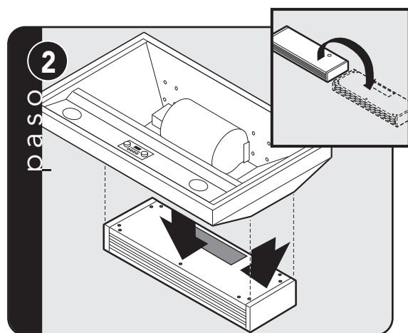
Coloque la unidad de recirculación cabeza abajo. Coloque la campana de ventilación cabeza abajo sobre la unidad de recirculación.
