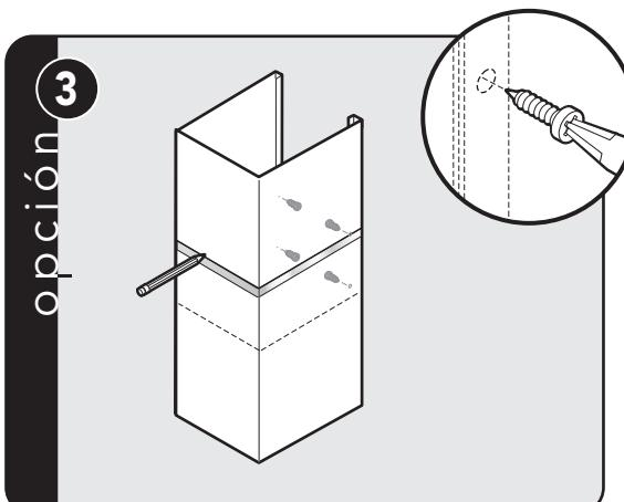
Coloque la parte superior de la tapa del conducto dentro de la base de la cubierta del conducto y bájela hasta alcanzar la altura deseada. Marque la altura. Use las tuercas de retención y los pernos para fijar desde el interior y quite la cinta.
