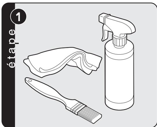
Préparez une solution savonneuse avec un volume de détergent liquide pour un volume d'eau. Vous aurez besoin d'un pulvérisateur, d'une brosse ou d'un chiffon pour appliquer la solution sur les raccords.
