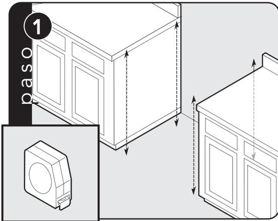
Mida las cuatro esquinas del área de la abertura para verificar que el piso está nivelado.
