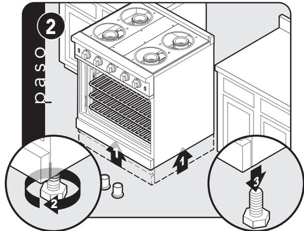
**Nota:** Se recomienda enfáticamente que se use un gato para paletas o un gato elevador en lugar de inclinar la unidad. Eleve la unidad aproximadamente un pie (0.3 m). Desatornille las patas provisionales de los acopladores.
