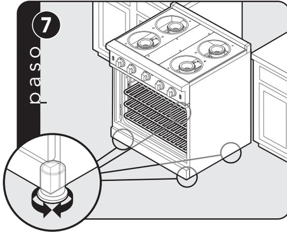
Coloque la esquina más alta de la estufa de tal manera que la parte superior de la moldura lateral quede a  $3/8''$  (0.95 cm) sobre la superficie del gabinete. Nivele la estufa con la esquina más alta.
