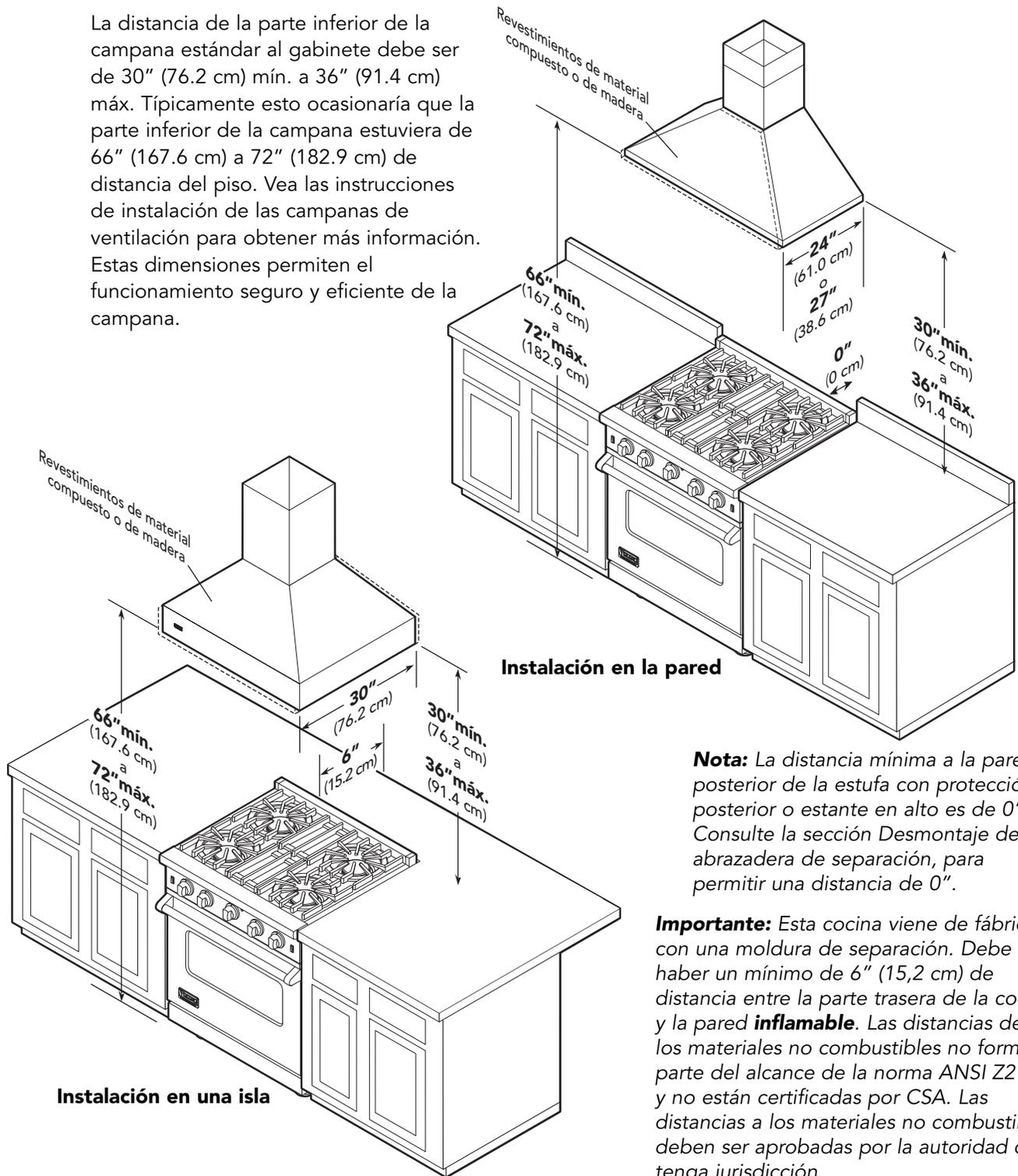
**Nota:** La distancia mínima a la pared posterior de la estufa con protección posterior o estante en alto es de 0". Consulte la sección Desmontaje de la abrazadera de separación, para permitir una distancia de 0".
