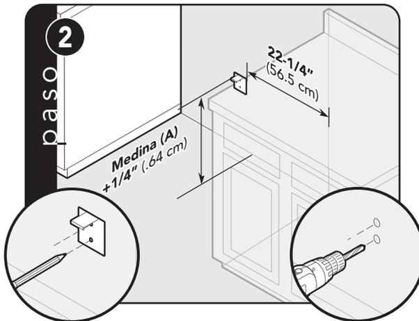
Ponga el dispositivo antivolcaduras en la pared posterior, con la esquina superior izquierda en la medida (A) más 1/4" (.64 cm) y a 22-1/4" (56.5 cm) de donde se va a colocar el lado derecho de la estufa (viendo la estufa de frente).
