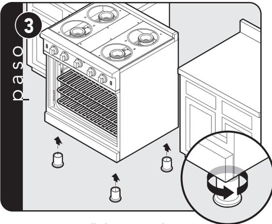
Atornille las patas en los acopladores de las cuatro esquinas.
