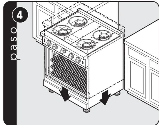
Baje la estufa lentamente para evitar cualquier tensión indebida en las patas y en el herraje interno de montaje.
