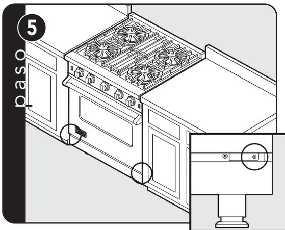
Si es necesario ajustar la puerta, afloje los tornillos del borde de la bisagra indicados en el paso 2. Ajuste los tornillos que se encuentran entre la puerta y la placa de protección, usando una llave Allen de 5/32". Después de ajustar la puerta, apriete los tornillos de las bisagras.
