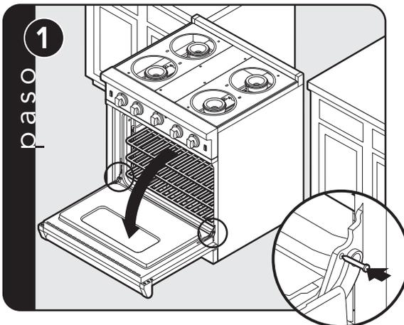
Abra la puerta completamente. Coloque en los orificios de las bisagras los pernos que se proveen con la unidad. Por razones de seguridad personal, **SÓLO** use los pernos que se proporcionan con la unidad.
