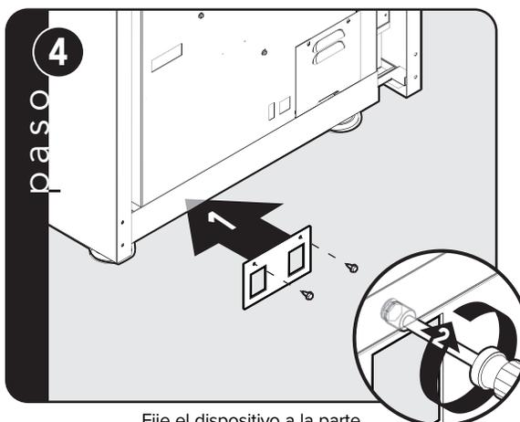
Fije el dispositivo a la parte posterior de la estufa con dos tornillos.
