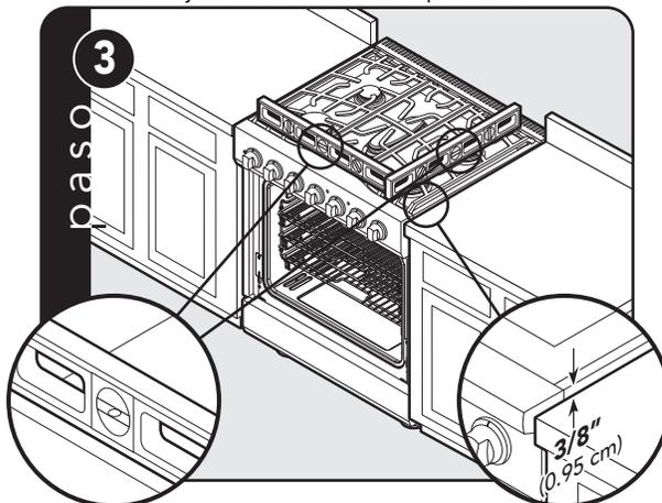
Verifique que la unidad esté nivelada de lado a lado y de atrás al frente. La moldura lateral debe estar a 3/8" (0.95 cm) por encima de la superficie del gabinete. Si la unidad no está nivelada, repita los pasos 5 al 7 de la sección "Nivelación/ Ajuste/ Alineamiento".
