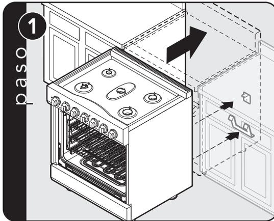
Coloque la estufa en su lugar. Asegúrese de que el dispositivo antivoltaduras encaje en la abertura correspondiente.
