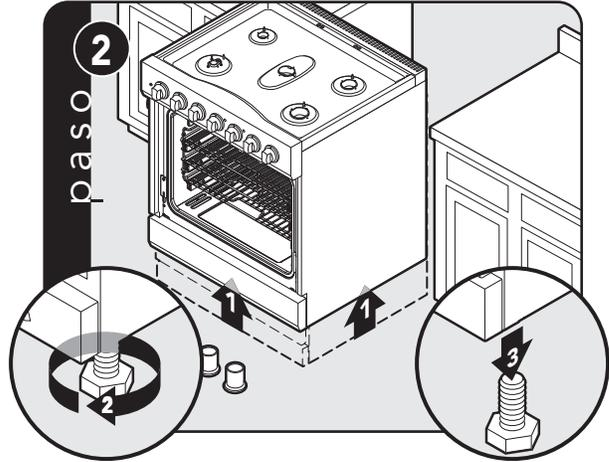
**Nota:** se recomienda enfáticamente que se use un gato para paletas o un gato elevador en lugar de inclinar la unidad. Eleve la unidad aproximadamente un pie (12 pulg). Desatornille las patas provisionales de los acopladores.
