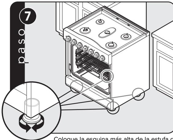
Coloque la esquina más alta de la estufa de tal manera que la parte superior de la moldura lateral quede a 3/8" (0.95 cm) por encima de la superficie del gabinete. Nivele la estufa con la esquina más alta.
