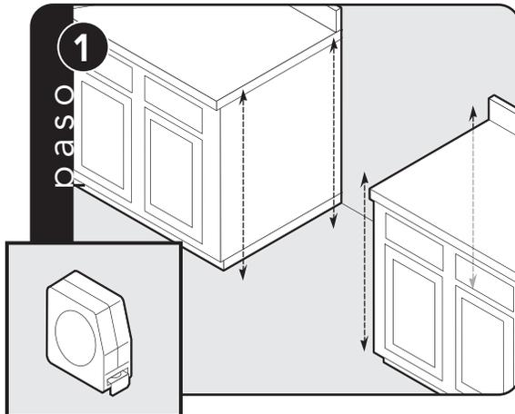
Mida las cuatro esquinas del área de la abertura para verificar que el piso esté nivelado.
