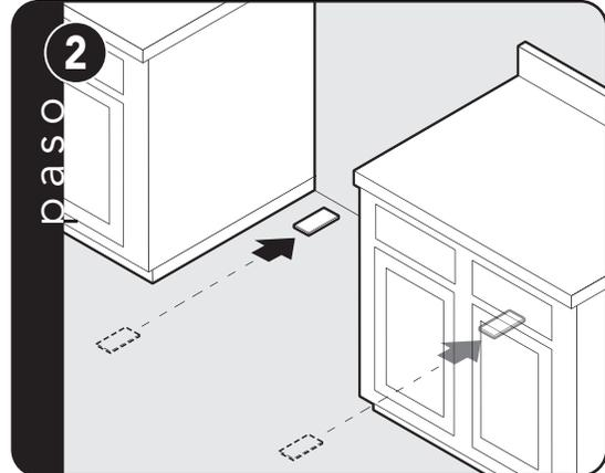
Para pisos desnivelados o con pendiente, nivele la unidad usando solamente cuñas de metal si el ajuste que se necesita excede la rosca disponible en las patas.
