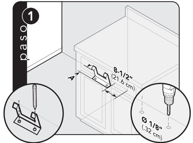
Refiérase a la tabla de dimensión basado en si se utilizan separadores con el dispositivo de ajuste trasero. Marque y haga agujeros de 1/8" (0.32 cm) donde se vaya a colocar el dispositivo.
