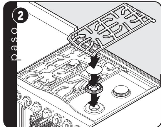
Las cabezas y las tapas de los quemadores se encuentran en el paquete de cartón que está en la parte superior junto con las parrillas. Alinee la cabeza del quemador en la base del quemador. Coloque la tapa del quemador sobre la cabeza del quemador. Coloque la parrilla en la bandeja del quemador.
