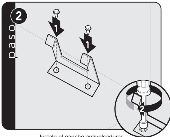
Instale el gancho antivolcaduras en el piso con los tornillos provistos.
